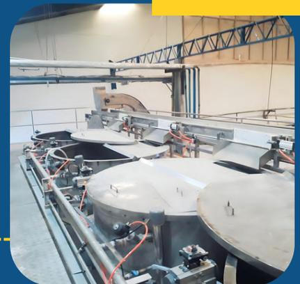
Dirancang khusus untuk perendaman bahan baku atau produk dalam cairan tertentu (air, larutan kimia, atau enzim) dalam jangka waktu tertentu. Ideal untuk proses pelunakan, pencucian, sterilisasi, atau reaksi kimia sederhana.
