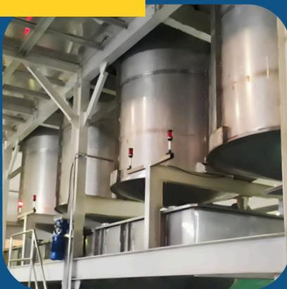
Tangki penyangga aliran (intermediate tank) yang berfungsi menstabilkan pasokan fluida dari satu proses ke proses berikutnya. Digunakan untuk mengurangi fluktuasi tekanan, volume, atau temperatur dalam sistem produksi berkelanjutan.
